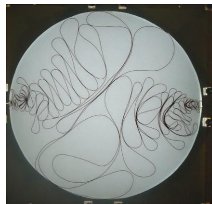
Figura 4: Um arranjo heterogêneo produzido no empacotamento de um fio de cobre em uma cavidade de 50,0cm diâmetro.
