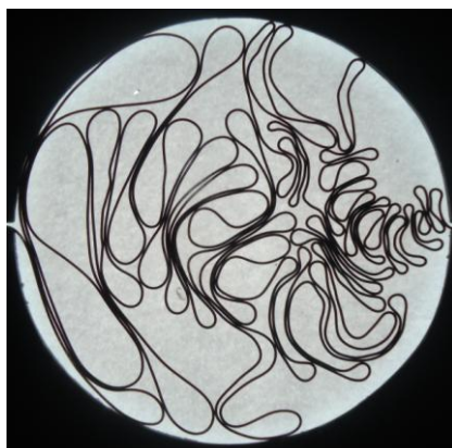
Figura 3: Um arranjo heterogêneo produzido no empacotamento de um fio de cobre em uma cavidade de 22,0cm diâmetro.
